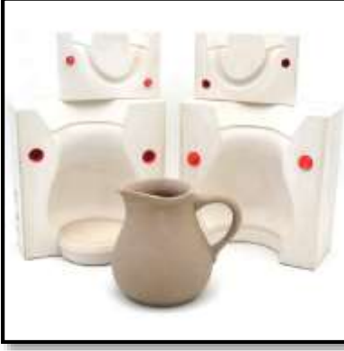
الشكل رقم(13) يوضح طريقة التشكيل بالصب في القالب
